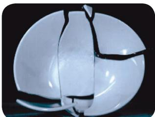
(1/2000秒の世界) 強化磁器破壊の瞬間
